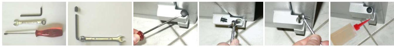
**Do smarowania zawiasów** należy dodać trochę oleju w szczeleinę między górną - dolną częścią zawiasu (zdjęcie 6) i ewentualnie wytrzeć roznany olej. Do smarowania nadają się wszystkie standardowe oleje smarowe.
