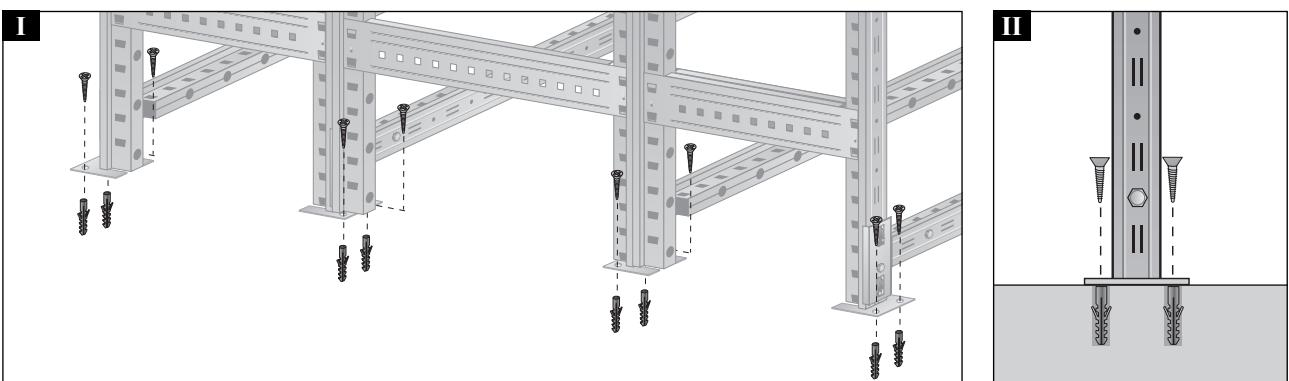
**D** Reifen-Doppelregale müssen mit den beiliegenden Bodenbefestigungen (geeignet für Estrich und Beton), gegen Kippen gesichert werden (siehe Abb. 6). Bitte Fragen Sie an, wenn die mitgelieferten Befestigungstools nicht für Ihren Boden geeignet sind. Gegebenenfalls ist eine alternative Befestigung nötig. Wir informieren Sie gerne näher.
