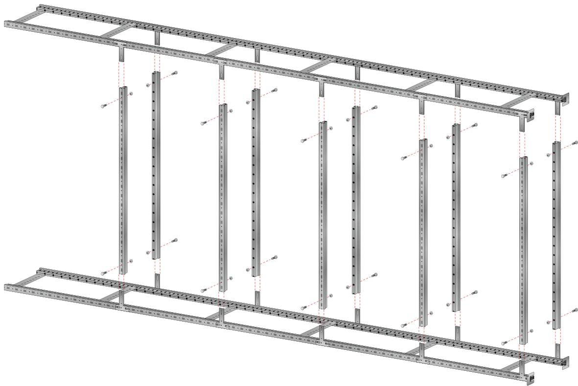
Wenn die Knoten und Pfosten gemäß Skizze 3.2 verschraubt wurden, können die die Reifenträger wie oben auf die Regalknoten gesteckt werden. Einen zweiter passender Rahmen wird aufgesteckt und jeder Reifenträger an beiden Seiten mit den Knoten verschraubt.
