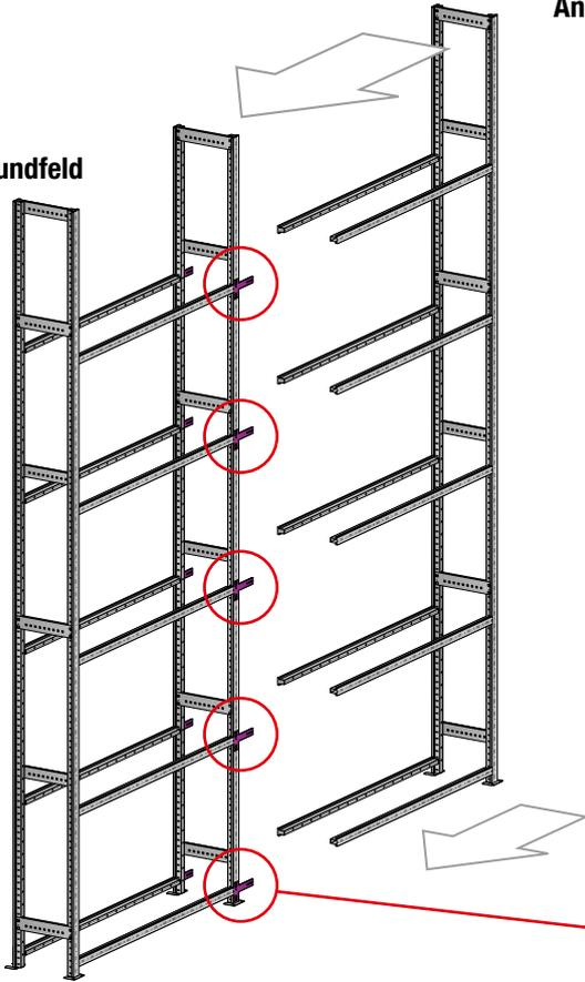
Wird eine Reihe aus mehreren Regalfeldern geplant, so benutzt das Anbaufeld die Rahmen des Grundfeldes mit.
