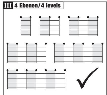
**D** Reifen-Einzelregale müssen ab 4 Ebenen mit den beiliegenden Wandbefestigungen (geeignet für Massivmauerwand wie z.B. Beton, Kalksandstein), und Bodenbefestigungen (geeignet für Estrich und Beton), gegen Kippen gesichert werden (siehe Abb. 5+6). Bitte Fragen Sie an, wenn die mitgelieferten Befestigungsutensilien nicht für Ihre Wand / Ihren Boden geeignet sind. Gegebenenfalls ist eine alternative Befestigung nötig. Wir informieren Sie gerne näher.
