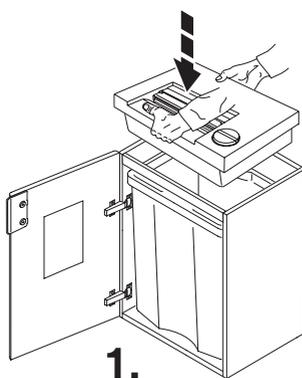
Avaa silppusäiliön ovi ja aseta laite silppusäiliön päälle ohjauspaneeli eteenpäin. **Varo sormia!**
