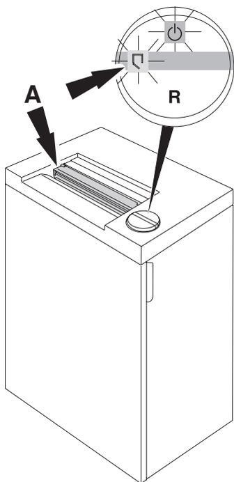
Laitte pysähtyy itsestään, jos turvakansi (A) avataan (Merkit  $\Delta$  ja  $\text{⏻}$  vilkkuvat vuorotellen). Sulje turvakansi ja aseta keinukytkin asentoon  $\text{⏻}$ . Laitte siippuaa paperit ja käy hetken turvakansi taaksepäin poistaakseen paperisilput teräpakasta. Tarvittaessa aseta keinukytkin asentoon "R" ja toista muutaman kerran.
