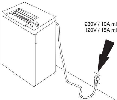
Zabezpečte voľný prístup k elektrickej zásuvke.
