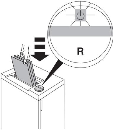
**A gép kikapcsol.** Túlterhelés elleni védelem.
