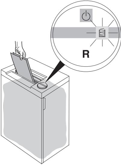
Laite pysähtyy itsestään, jos silppusäiliö on täynnä. "Säiliö täynnä" -merkki
