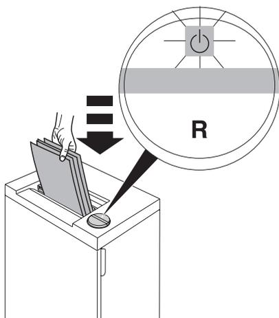
La macchina si ferma automaticamente se si inserisce troppa carta. Inversione automatica in caso di blocco. (Il simbolo "ON/OFF"
