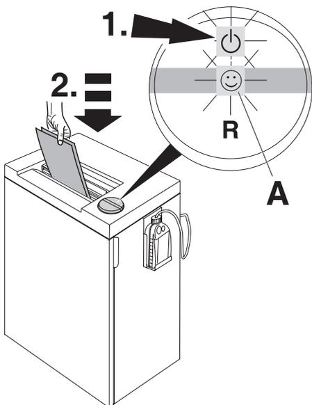
Stlačte viacfunkčný prepínač ⏻ (1.): svieti zelená dióda, stroj je teraz pripravený na prevádzku. Automaticky sa spustí, keď sa do skartovacej štrbiny vloží papier. Ak sa v priebehu 1 hodiny nevloží do skartovacej hlavy papier, stroj sa automaticky vypne. Zelená kontrolná dióda ⏻ prestane svietiť.
