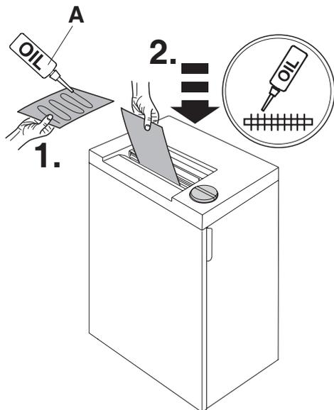
Při snížení řezací kapacity nebo po naplnění odpadového prostoru naolejujte řezací mechanismus!/viz. obrázek)
