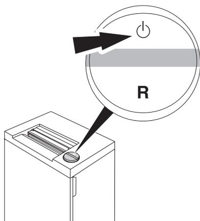
Automatický standby režim – vypnutí po 30 minutách. Stroj lze vypnout kdykoliv stisknutím tlačítka
