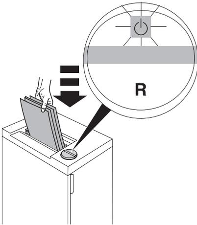
Laite pysähtyy itsestään liian montaa paperia syötettäessä kerralla. Laite syöttää paperit itsestään takaisin, jos silppuri tukkeutuu. (ON/OFF-merkki
