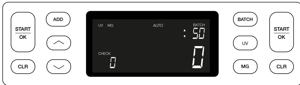
**2.3.** Gebruik de pijltjestoesten om het batchaantal met stappen van 1 te verhogen of te verlagen, uitgaande van het getoonde aantal. Als '100' op het scherm staat kunt u naar 101, 102 enz. gaan door op te drukken, en naar 99, 98 enz. door op te drukken.
