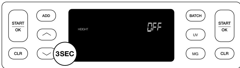
Tenga en cuenta que, con esta configuración, el dispositivo no podrá detectar billetes de altura y/o anchura diferentes cuando éstos se incluyan en el fajo contado.
