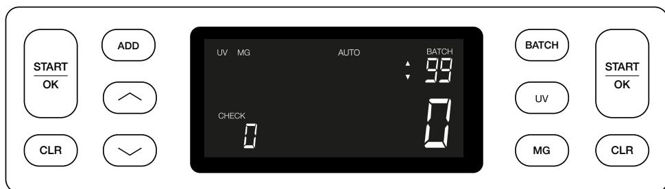
**2.4.** Bestätigen Sie die Bündelnummer durch Drücken der **START**-Taste. Danach bleibt die eingestellte Bündelnummer sichtbar auf dem Bildschirm.
