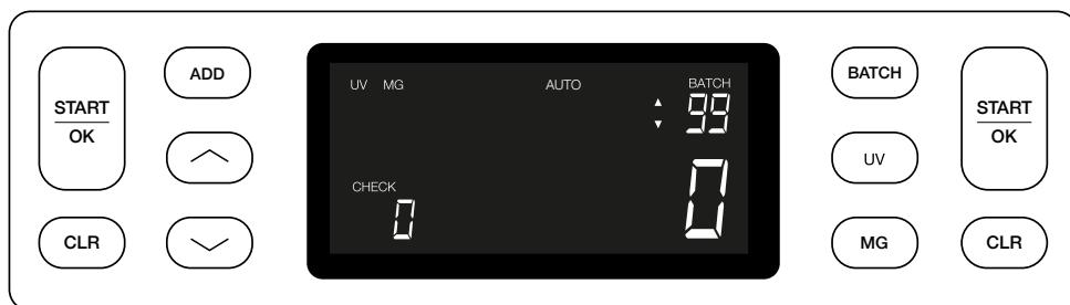
**2.4.** Bevestig het ingestelde batch-aantal door op de **START** knop te drukken. Hierna blijft het batch-aantal zichtbaar op het scherm.
