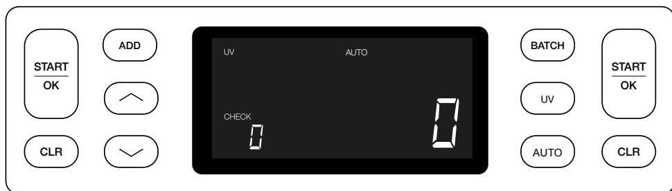
Safescan 2250: stiskněte a držte tlačítko **START** po dobu 3 sekund k aktivování/deaktivování funkce automatického spuštění počítání.
