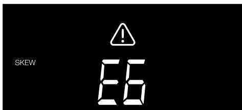
Bancnota a trecut prin aparat într-o poziție înclinată (nu a intrat drept în interiorul aparatului).
