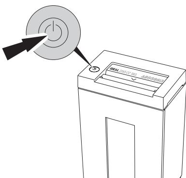
**DE** Autom. Standby - Abschaltung nach 30 Minuten. Maschine kann jederzeit durch 2 sec. langes Drücken des ⏹ Schalters ausgeschaltet werden. Grüne Kontrollleuchte ⏹ erlischt. Danach verbraucht die Maschine keinen Strom mehr. Innerhalb dieser 30 Minuten verbraucht der Aktenvernichter folgende Wh Energie.
