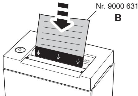
**ES** Si la capacidad de hojas se reduce o si la receptáculo está llena, recomendamos que lubrique el mecanismo destructor! (mirar dibujo) Para el modelo de corte en tiras utilizar el bote de aceite (**A**) Para el modelo de corte en partículas, utilizar el bote de aceite o las hojas con aceite (**B**) Consultar las referencias de ambos artículos (**A** y **B**) en la página 29.
