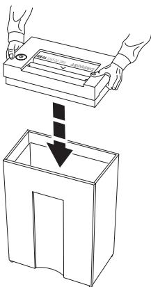
**DE** Maschine in den Auffangbehälter setzen.
