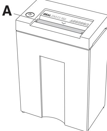
**DE** Maschine darf ohne Sicherheitsklappe (**A**) nicht betrieben werden!
