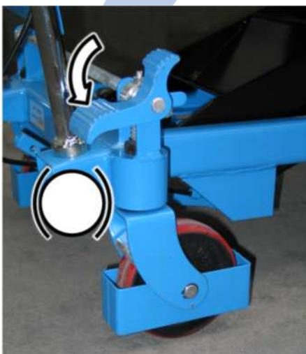
Şekil 5 Frenin etkinleştirilmesi
