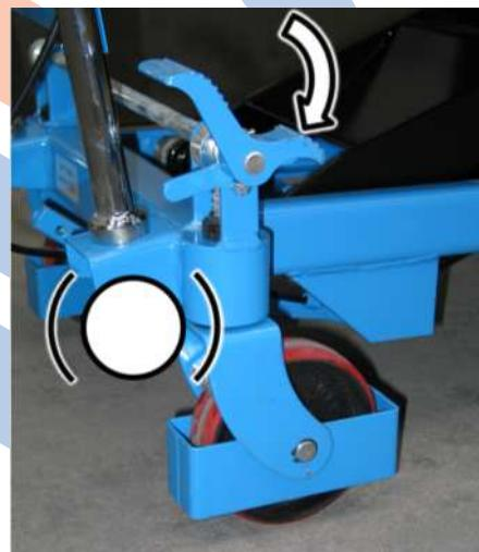
Obrázok 6 Uvoľnenie brzdy
