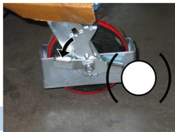
Obrázok 4 Uvoľnenie brzdy
