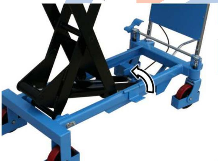
При выполнении обслуживания или ремонта необходимо установить фиксатор от опускания так, как показано на рисунке. Следует убедиться, что рукав поддерживает обе стороны и оба фиксатора надежно закреплены.
