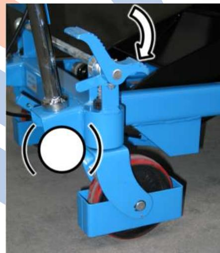
Obrázek 6 Uvolnění brzdy
