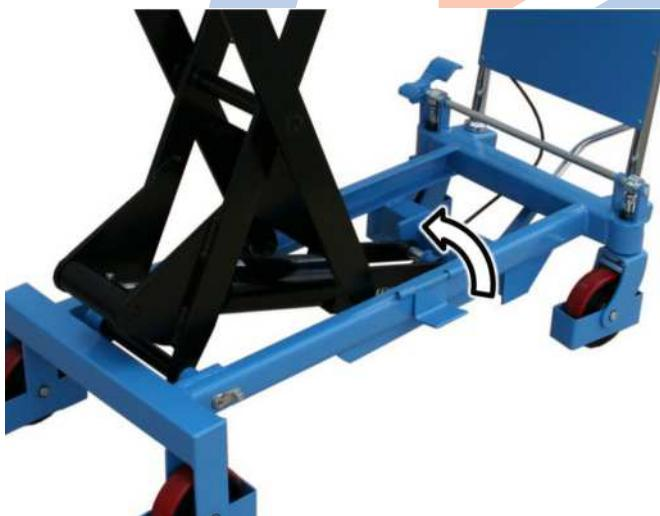
Pro údržbářské práce nebo opravy vložte pojistku proti spuštění tak jak je zobrazené. Přesvědčte se, že obě strany jsou přeloženy a pojistky proti spuštění jsou bezpečně zajištěny.
