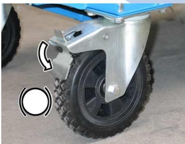
Şekil 7 Frenin etkinleştirilmesi
