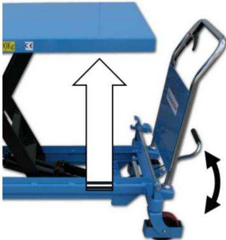
Para elevar a plataforma da mesa, pressione o pedal conforme ilustrado.
