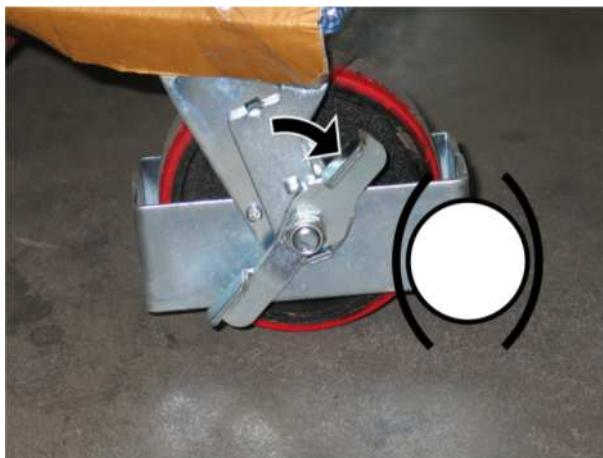
Şekil 3 Frenin etkinleştirilmesi
