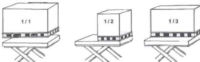
Bild 1 Lastens fördelning
