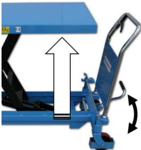
Platformu kaldırma için ayak pedalına gösterildiği gibi basın.
