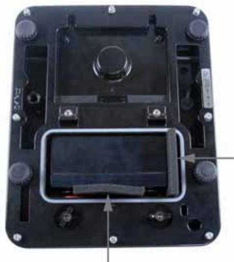
⇒ Inserire l'accumulatore in modo che non possa scivolare (bloccarlo con elementi in spugna).
