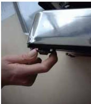
Выровнять весы при помощи регулируемых ножек, пузырек воздуха в сферическом уровне должен находиться в обозначенной зоне
