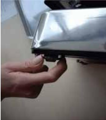
Procéder à la mise à niveau de la balance à l'aide des vis des pieds, jusqu'à ce que la bulle d'air du niveau se trouve dans le cercle prescrit.
