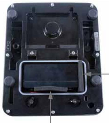
⇒ Włożyć akumulator w taki sposób, aby nie miał możliwości ześlizgnięcia (zablokować elementami z pianki).
