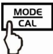
⇒ Waage entlasten, **TARE** drücken und **MODE**-Taste wiederholt drücken bis „**PtArE**“ blinkend angezeigt wird.
