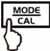
⇒ Im Wägemodus **MODE**-Taste kurz drücken. Referenzstückzahl „5<sup>PCS</sup>“ wird blinkend angezeigt.
